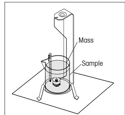
Pesaje de una muestra con empuje hidrostático
