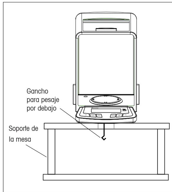
Balanza con gancho para pesaje por debajo instalado
