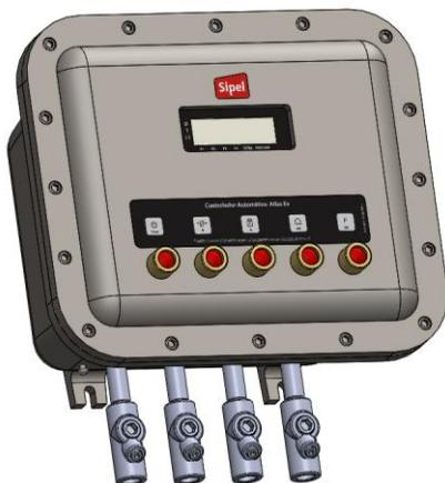
Este cabezal está específicamente diseñado para trabajar en ambientes clasificados de alto riesgo por lo que la electrónica del mismo se encuentra alojada en un gabinete antiexplosivo y se conecta a la plataforma a través de barreras de seguridad intrínseca acordes a la clasificación del área donde se utilizará. Cuenta con 2 salidas serie RS232, una destinada a PC / Impresora y la otra para Display Repetidor. Opcionalmente puede ser comercializado con salida 4-20mA ó RS485.
