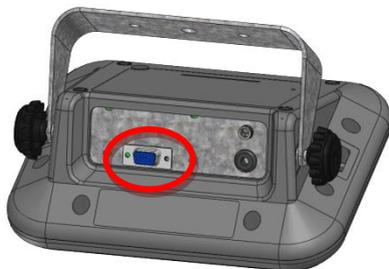
En todos los casos, para conectar la celda de carga deberá usar un cable mallado de al menos cuatro conductores.
