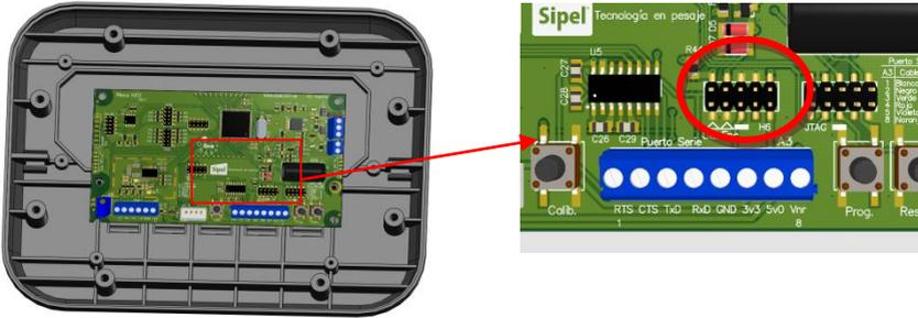
Desenergice el equipo, retire los 8 tornillos ubicados en la parte trasera del indicador y separe la tapa de la base. Ubique el Conector H6 sobre la placa principal y coloque allí un jumper en la posición 1. Vuelva a ensamblar el indicador.
