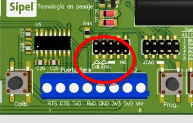
Para que el equipo permanezca siempre encendido deberá montar un JUMPER en la posición 2 del conector H6 de la placa principal del indicador. Se lo puede identificar mediante la leyenda "Enc" junto con la flecha que apunta a la posición correspondiente.
