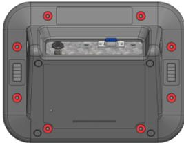
Abrir el equipo aflojando los 8 tornillos de la parte posterior
